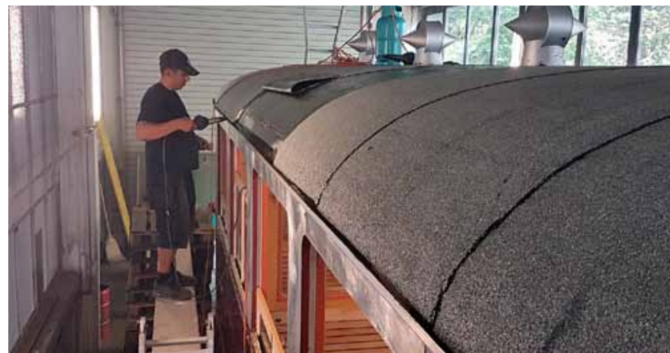
Die neuen Klebefolien werden fachmännisch auf das Fahrzeugdach geklebt.
